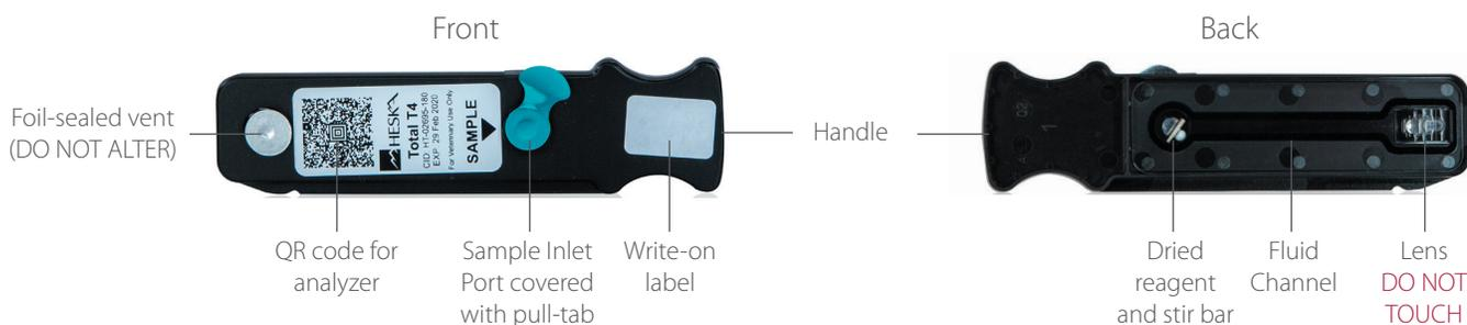
**AVOID TOUCHING THE CARTRIDGE BOTTOM • THE ANALYZER READS THROUGH THE BOTTOM**
